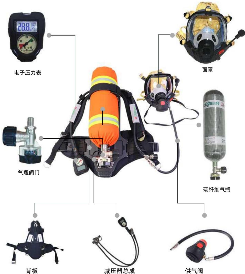
道雄RHZK6.8CT/B空呼由背托、气瓶、快速充气管、阻燃气瓶保护套、供气阀、减压阀、导管、低压报警器、全面罩、压力平视装置、通讯扩音系统与对讲机接口相匹配，快速充气装置。
