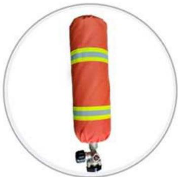
碳纤维气瓶水容积 6.8L 带有压力表显示,外套带反光标识，标志符合国家消防救援局标准。气瓶阀为右手设计，自锁功能采用整体按压式设计，方便穿戴手套操作，接口为可拆卸式快速接口。
