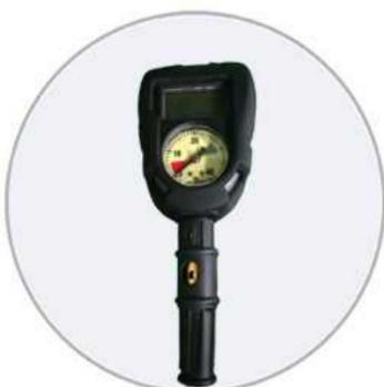
电子报警器及压力表：为一体化设计，置于使用者前胸部；报警压力  $5.5 \pm 0.5 \text{ MPa}$ ，连续声响时间至少应以 90dB (A)的声强持续  $\geq 15\text{s}$ ，带有呼救器功能；电气元件的防爆性能应符合Ex ia IIC T4 级的规定，IP67 防尘防水等级，
